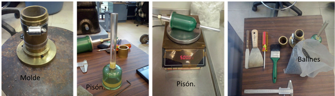
Figura 3. 7 Materiales para prueba de compactación por amasado.
