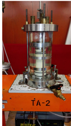
Figura 4. 1 Ensayo de probetas en la cámara triaxial de alambres TA-2.
