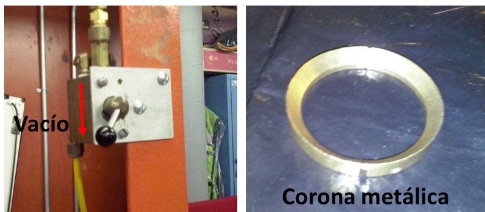
Figura 3. 16 Sistema de vacío y corona metálica
