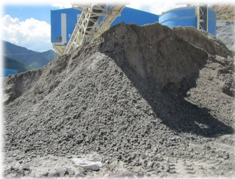
Figura 1. 5 Aspecto del jal semiseco antes de ser bandeado y compactado
