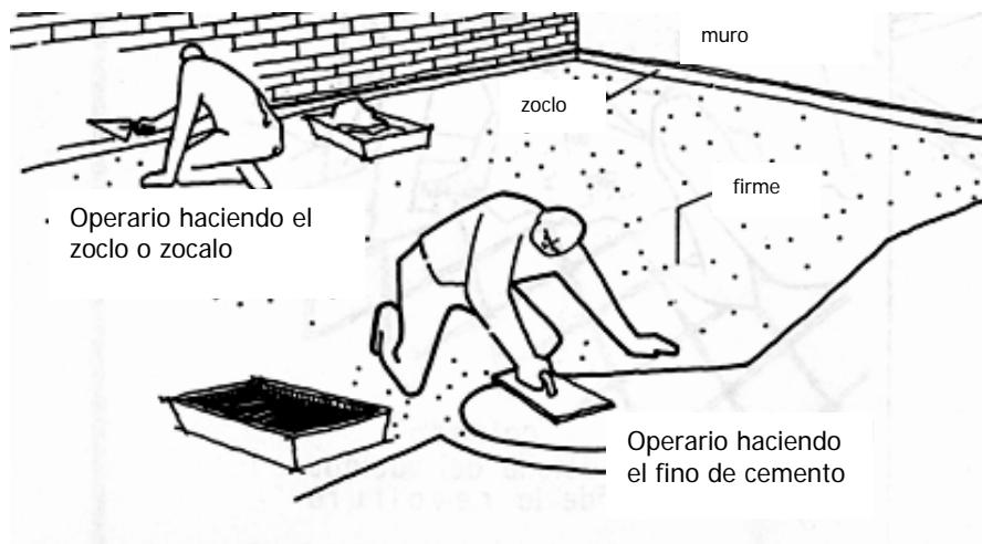
Figura 12 Piso de cemento
