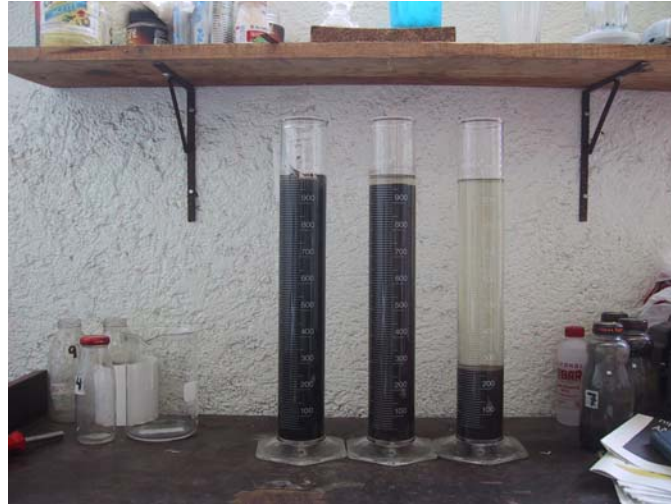
Figura 4.14 Prueba de sólidos sedimentables.
