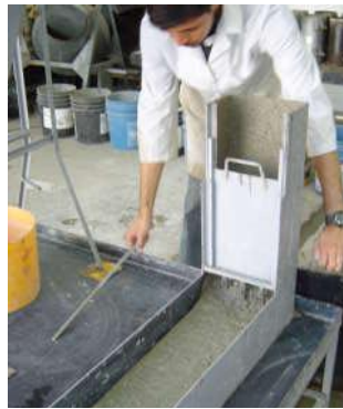
Fig. 3.15 Caja L con concreto.
