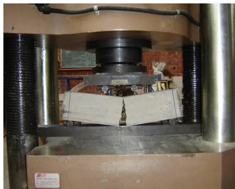
Fig. 4.14 Prueba de tensión por flexión en vigas.
