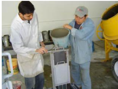
Fig. 3.14 Caja L siendo llenada con concreto.
