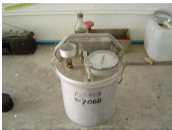
Fig. 3.3 Dispositivo empleado para determinar el contenido de aire.
