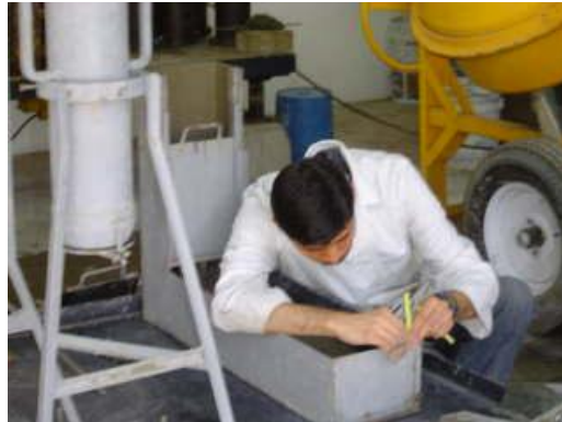
Fig. 3.16 Medición de alturas en la caja L.
