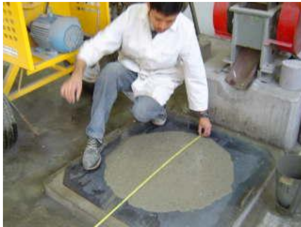
Fig. 3.9 Medición del diámetro final del concreto.
