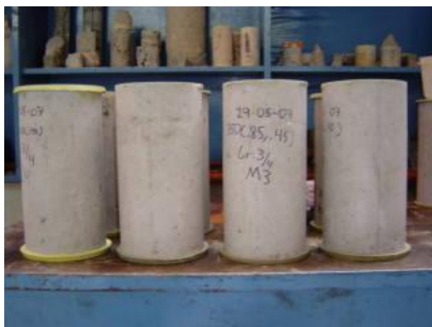
Figura 4. Probetas de concreto autocompactable.
