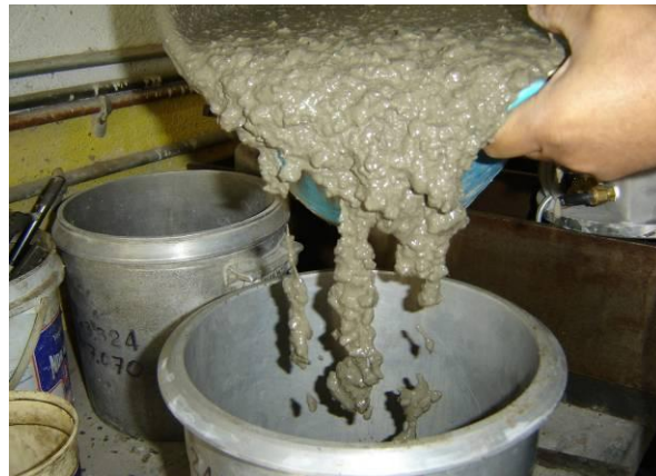
Fig. 3.5 Concreto autocompactable en estado fresco.
