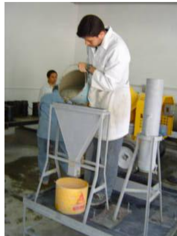
Fig. 3.23 Embudo V siendo llenado con concreto.
