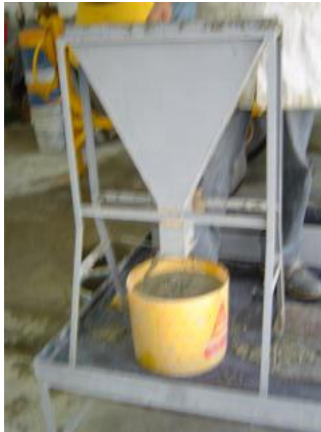
Fig. 3.24 Concreto desalojado por el embudo V.
