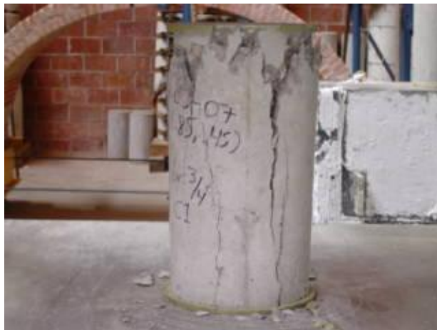
Figura 4.1 Cilindro de concreto después de ser ensayado.
