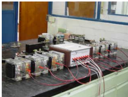
Fig. 4.23 Dispositivo utilizado en la prueba de permeabilidad a los cloruros.
