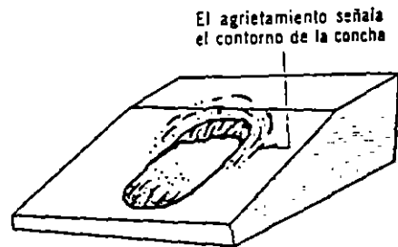
b) Falla concoidal.
