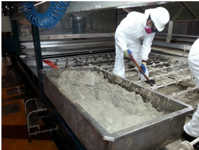
Figs. 5-6 y 5-7 Recuperación costras de lodo residual en cabina de plateado
