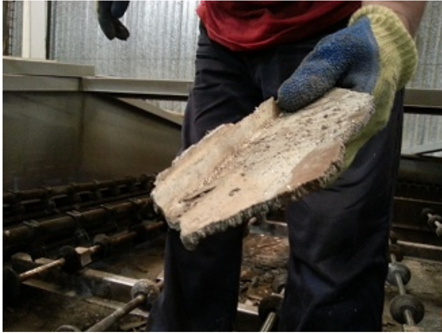
Fig. 5-4 Ejemplo de costra de lodo residual formada al fondo de las tinas
