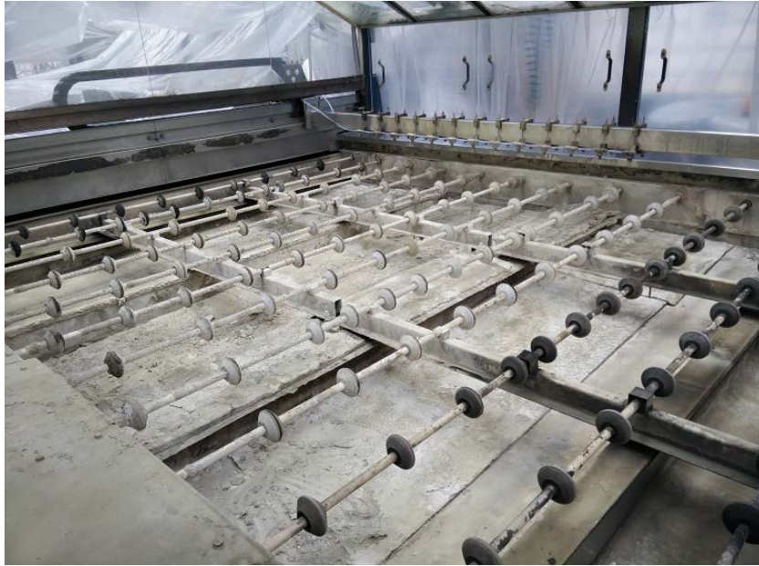
Fig. 5-16 Costras de lodo formadas sobre tela-filtro
