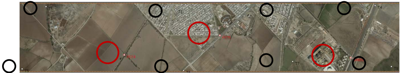
Ilustración 6: Ejemplo de la ubicación de Puntos de Pase (Negro, círculos pequeños) y Puntos de Control Terrestre (Rojo, círculos grandes).
