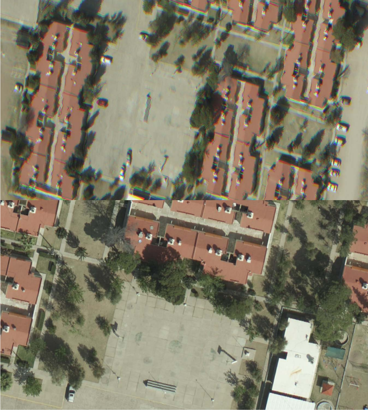
Ilustración 20: Imagen Nadir antes (arriba) y después (abajo) de la rectificación.
