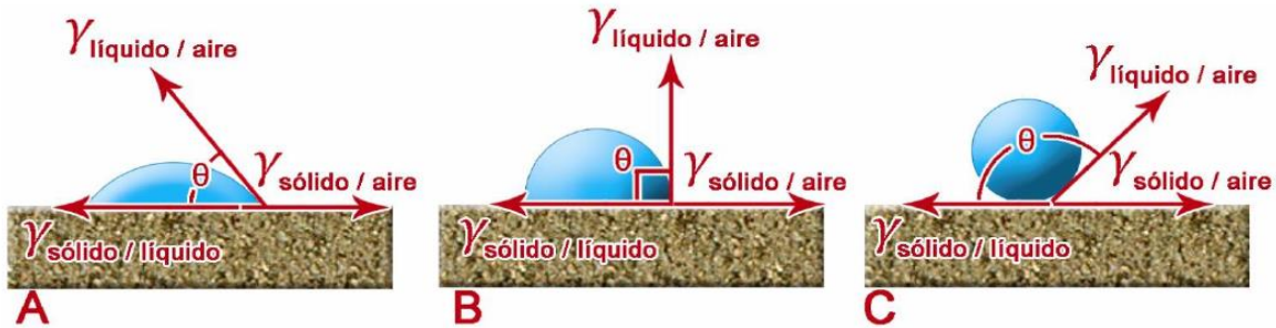
Fig. 4.4.- Gota de agua sobre tres diferentes superficies sólidas, sistema sólido/agua/aire. De A a C disminuye la atracción por el líquido.
