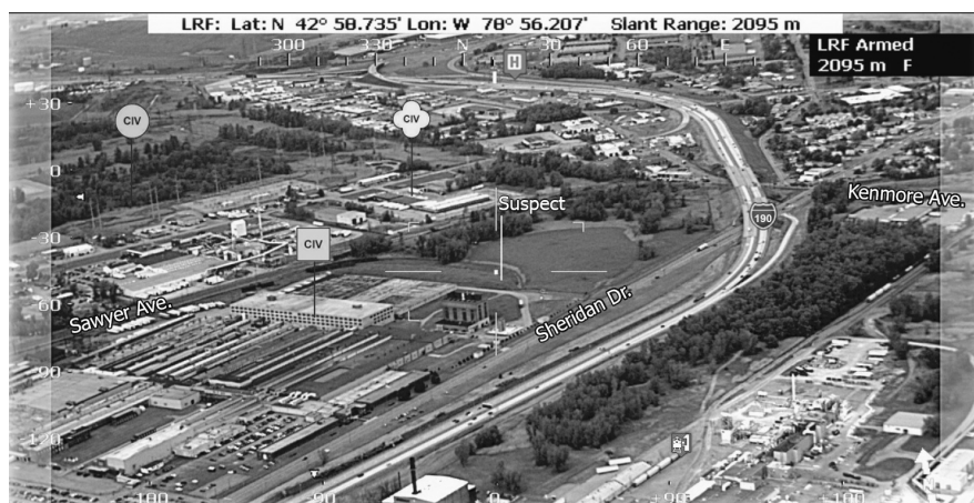
Figura 11. LandForm+ es un sistema de realidad aumentada con geolocalización utilizado para la búsqueda, rescate y administración de emergencias.
