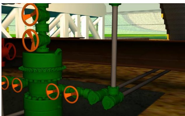
Figura 76 Punto de aplicación de la fuerza es sobre la válvula de 11 pulgadas, el eje de rotación se encuentra en el contacto del equipo con la salida lateral del cabezal.
