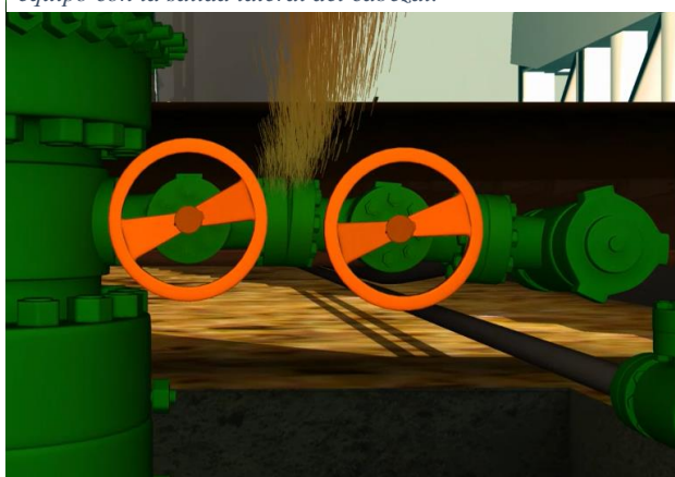
Figura 76 Punto de aplicación de la fuerza es sobre la válvula de 11 pulgadas, el eje de rotación se encuentra en el contacto del equipo con la salida lateral del cabezal.
