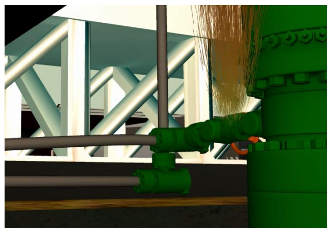
Figura 77 Fuga de hidrocarburos por válvula lateral
