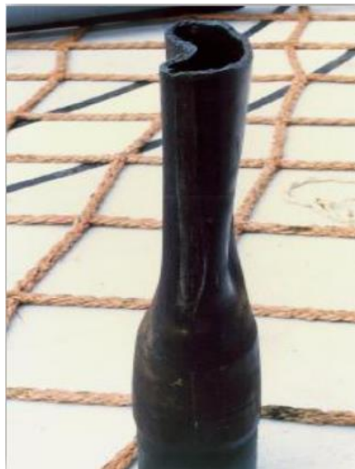
Figura 14 Ejemplo de tubería bajo efecto de colapso. Fuente: Investigación del fenómeno de colapso en tuberías de revestimiento y producción. Tenaris-Tamsa.
