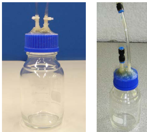
Figura 4.2 Botellas utilizadas como reactores
