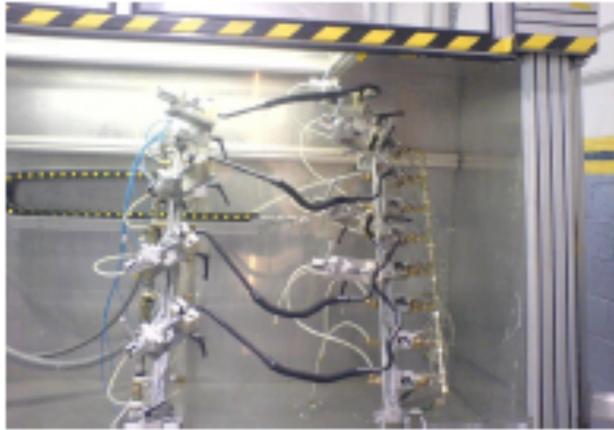
Figura 5.40. Prueba de Fuga
