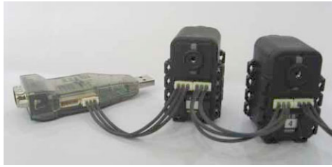
Figura A.4: Conexión de motores en Daisy Chain
