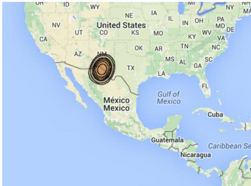
Figura 5.2.1 Ejemplo de interferencia de un haz del satélite ViaSat 1 en territorio mexicano.
