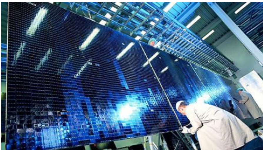
Figura 1.5.2 Sistema de energía de un satélite.
