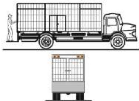
**Fig. 2.1 Camión especial para plásticos recuperados**
