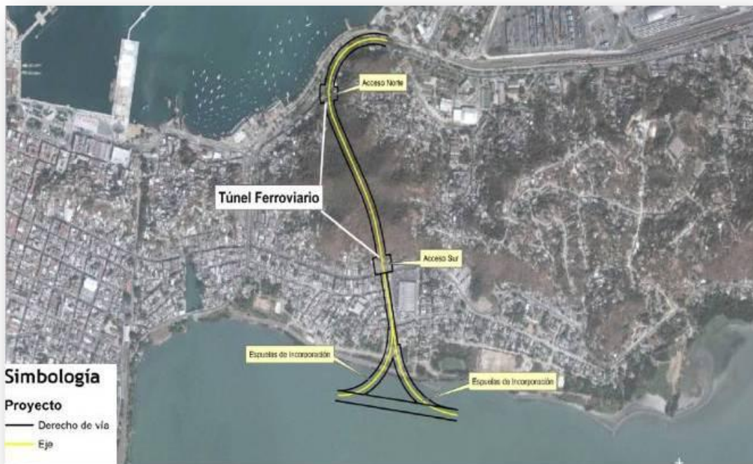
Figura 39. Túnel Ferroviario y vialidades adyacentes a los portales. Manzanillo, Colima.
