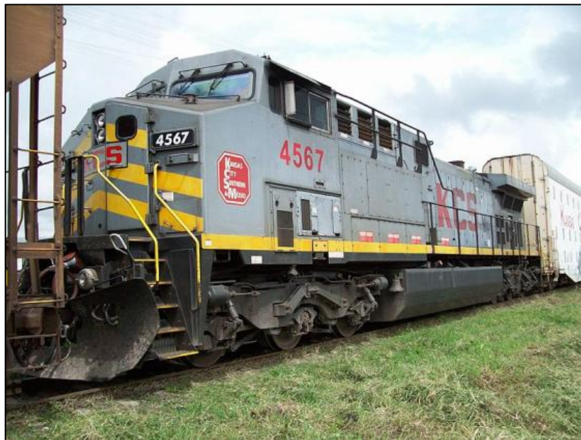
Fotografía 31. GE AC4400CW. 4,400 Hp's Marcaron la modernización de la FM en México
