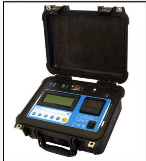
Imagen 19. Equipo de medición Modelo MEGABRASS TM25R
