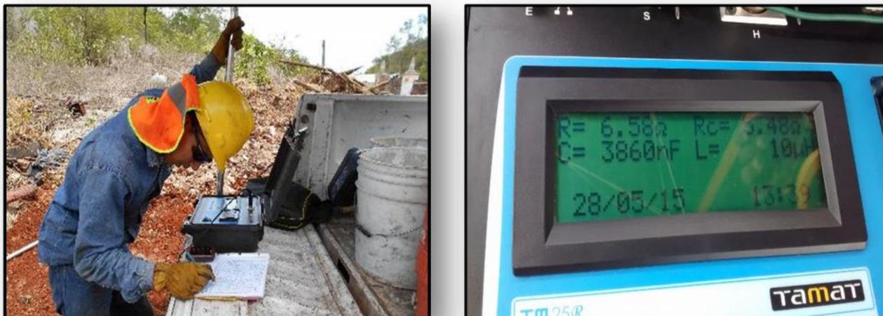
Imagen 46 y 47. Medición de resistencia final al concluir los trabajos de MSPT en estructuras de la GRTP – 2014.
