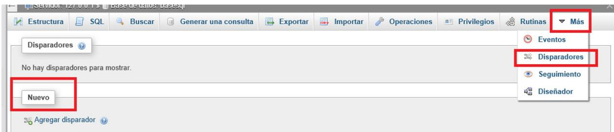
*Figura 4.2.8 Creación de un trigger*
