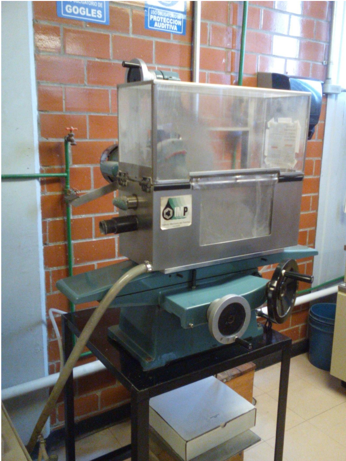
Figura 4.13. Afinadora de tapones del laboratorio de mecánica de rocas del IMP.
