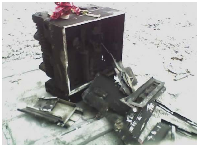
Figura 1.9 Ejemplo de lo que sucedió por un descuido en la configuración de un relevador, esto es solo el interruptor del tablero tipo Metal, cuando los daños al propio tablero también tuvieron grandes proporciones
