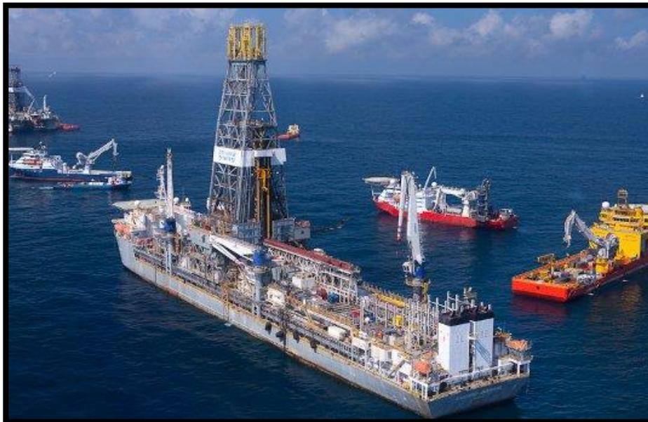
Figura 5.4. Barco perforador (Cárdenas et, al, 2013).
