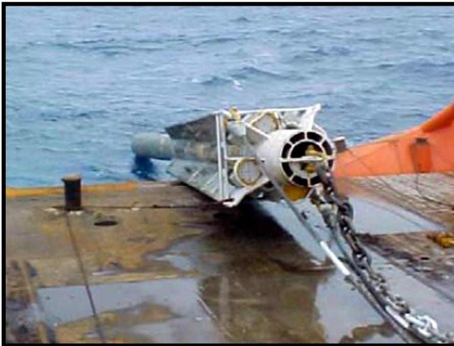
Figura 5.8. Torpedo base lanzamiento desde AHV (Cárdenas et, al, 2013).
