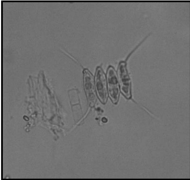
Microfotografía F. 5 Única alga de la especie Scenedesmus sp. Identificada en las muestras de agua previamente tratada por el proceso DAF, con un objetivo 40x y un ocular 10x.
