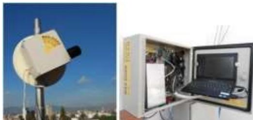
**Fig. 41.** Perfilador de gases MAX-DOAS de la UNAM. [19]
