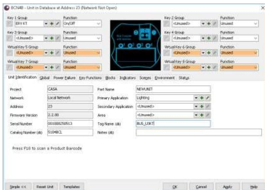
**Fig. 103.** Ventana de configuración del acoplador de bus.
