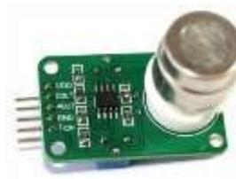
**Fig. 45.** Módulo de CO<sub>2</sub> con el sensor MG-811. [26]
