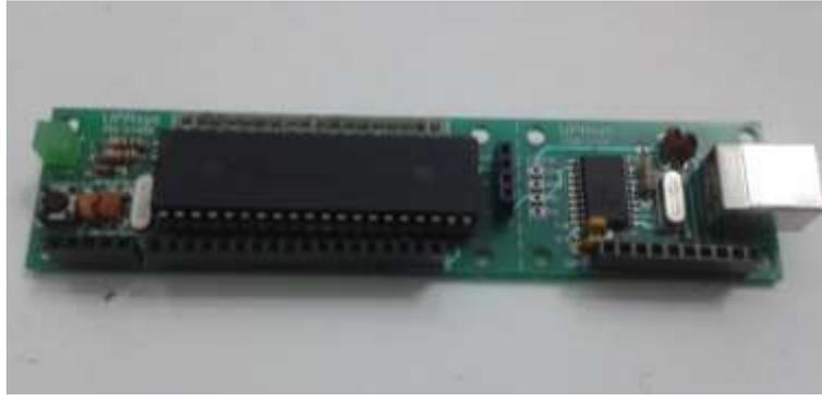
**Fig. 111.** Circuito impreso con microcontrolador PIC 16F887 e interfaz USB desarrollado por el M en I Ulises Peñuelas.
