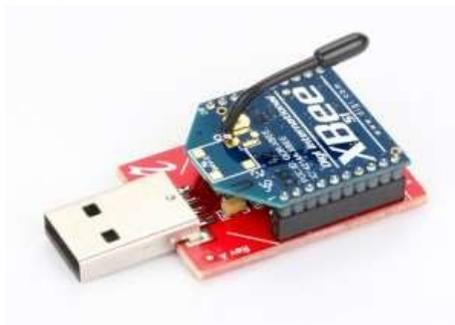
**Fig. 106.** USB Explorer Dongle para programación del Xbee. [59]
