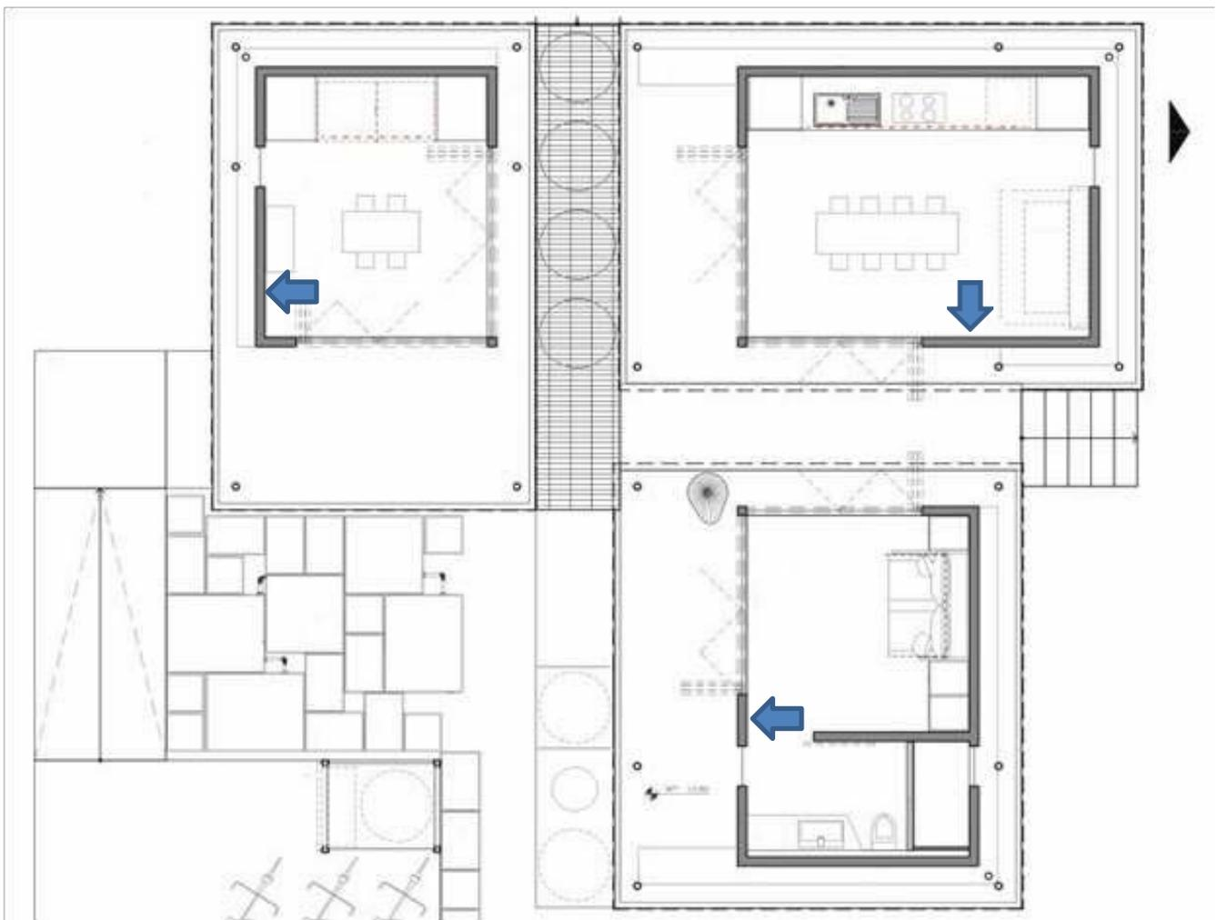
**Fig. 72.** Ubicación de los puntos a intervenir para la instalación de los sensores de medición de variables de confort.
