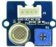
**Fig. 44.** Módulo de VOC's con el sensor WSP2110. [25]
