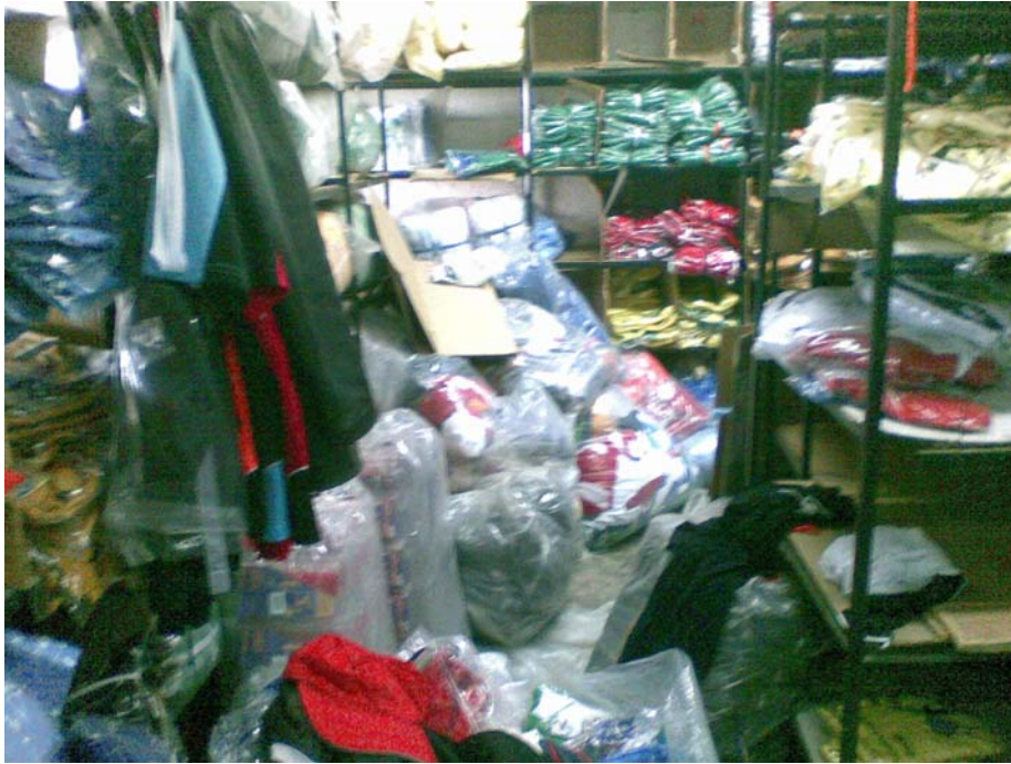
Imagen 15 Obstrucción de las rutas de evacuación en el área de productos terminados.
