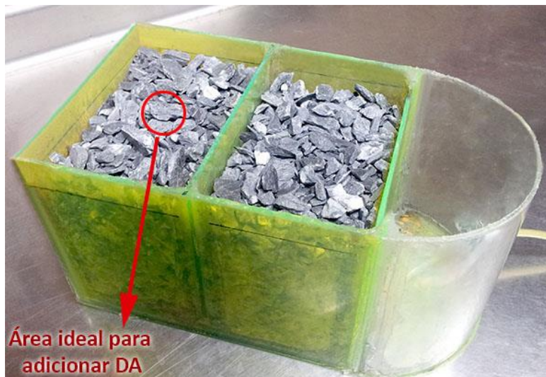
Figura 29. Celda de tratamiento empacada con roca filita
