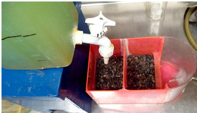
Figura 20. Circulación del DA a través de la celda empacada con roca caliza
