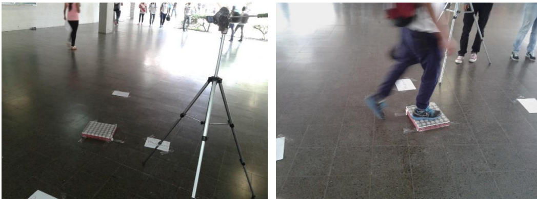
Figura 70 Prueba de marcha sobre baldosa
