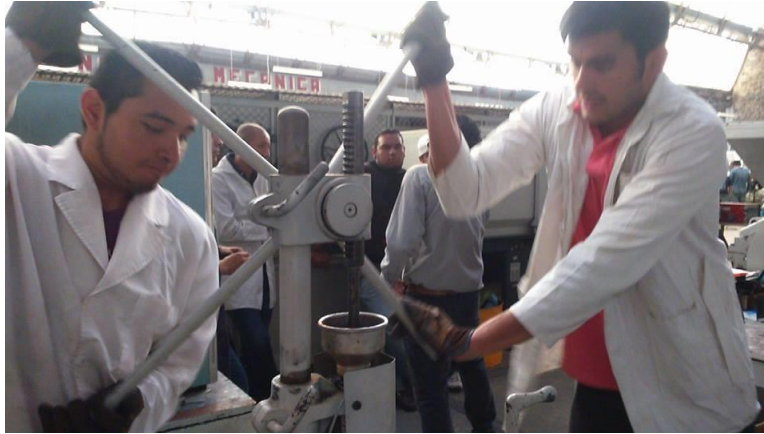
Figura 59 Inyección del material.
