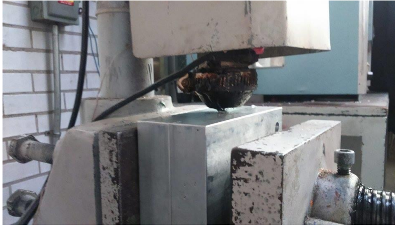
Figura 57 Colocación del molde
