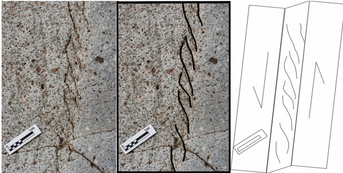
Figura 19: Fracturas en echelón, indicando un desplazamiento de sentido izquierdo. Generadas en un régimen de deformación frágil.
