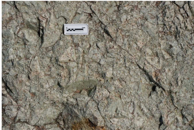
Figura 18: Estructura brechoide en la zona Los Amates. El tamaño de los fragmentos es de escala centimétrica y están embebidos en una matriz ígnea. Esta textura es generada a través de un proceso de cataclasis, en un régimen de deformación frágil.
