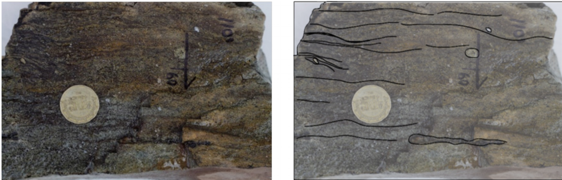
Figura 16: Muestra orientada colectada en la localidad Los Amates. Se observan fenocristales de cuarzo y feldespatos embebidos en una matriz fluidal; los cristales son indicadores concordantes con un desplazamiento lateral izquierdo.
