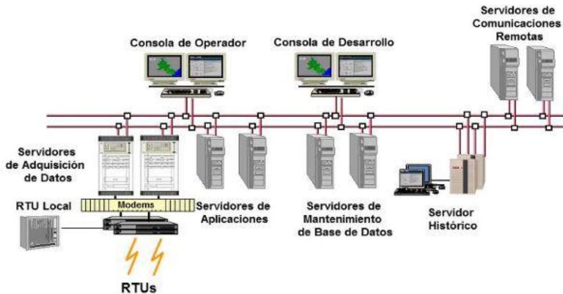
Figura 11 Diagrama de Sistema EMS
