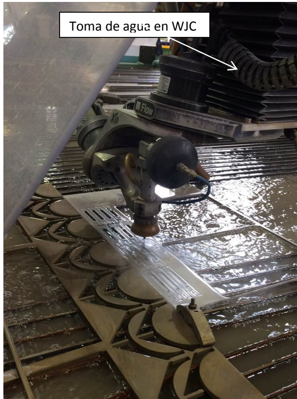
Figura 3.10 Toma de agua para generar el corte en la WJC (Cortadora ubicada en CCADET)
