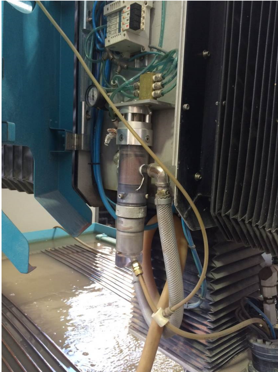
Figura 3.12 Toma de abrasivo para generar corte en la WJC (Cortadora ubicada en CCADET)
