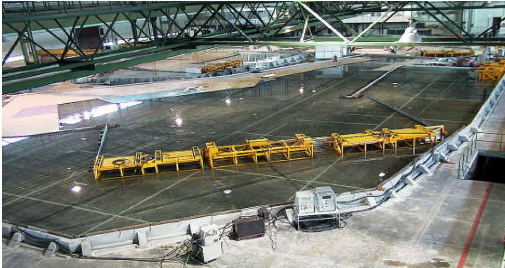
Fig 3.4 Modelo físico del ensayo de agitación de la ampliación del puerto de Barcelona (Gutiérrez, 2003).
