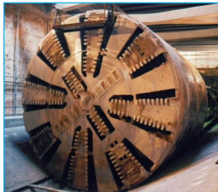
Fig 2.23 Escudo de frente cerrado, cabeza de corte de la tuneladora “La Almodena” (fuente: http://ecomovilidad.net/madrid/tuneles-madrid-tuneladoras/ , 2009).
