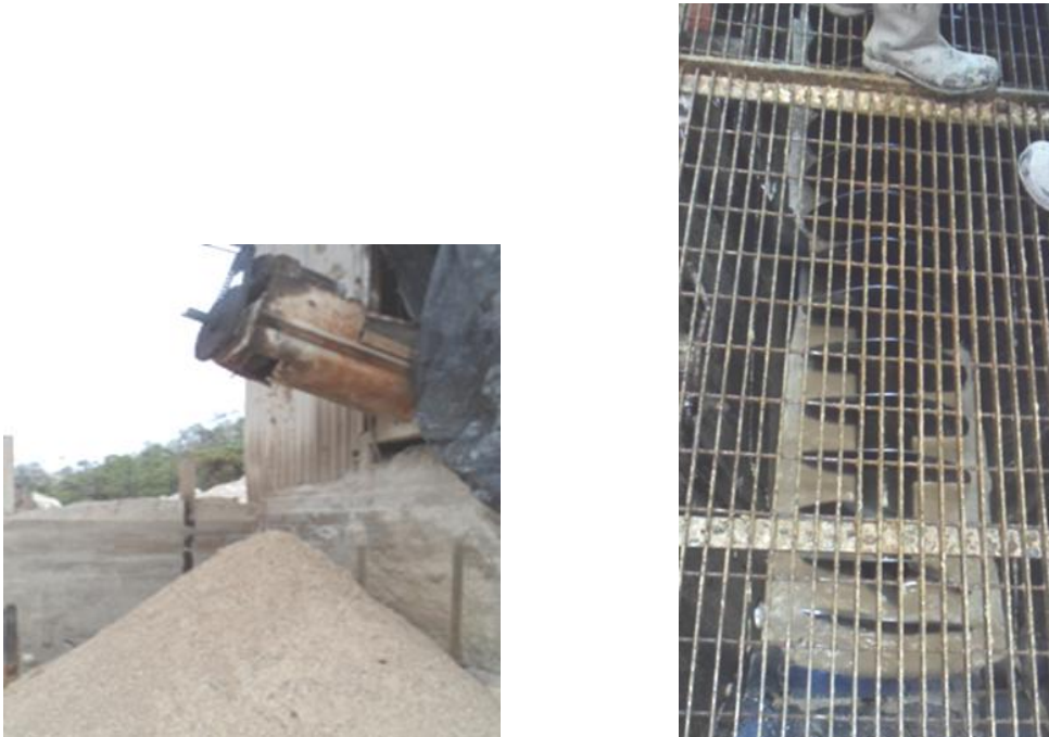
Figura 6.9 A la izquierda, una pila de mineral ya concentrado. A la derecha, se observa un tornillo sinfín para distribuir el concentrado.
