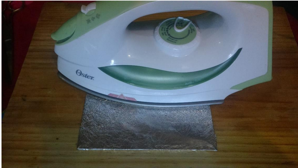
Figura 4.3-8 Transferencia del circuito con una plancha
