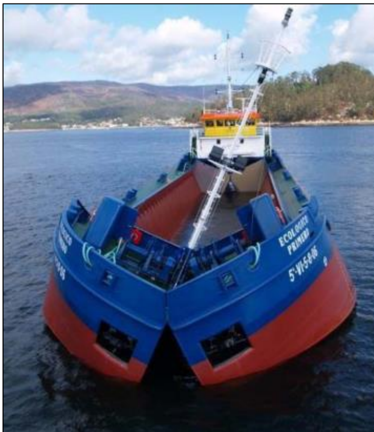
Figura 3.6 Embarcación para la colocación de los materiales
