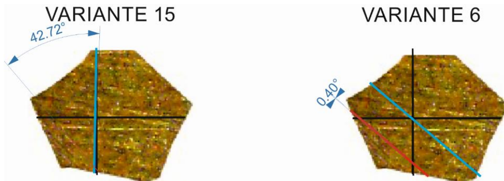
Figura 4.40. Comparativo de la aparición de VM in situ vs líneas testigo simuladas para grano R02-G07 en tensión.
