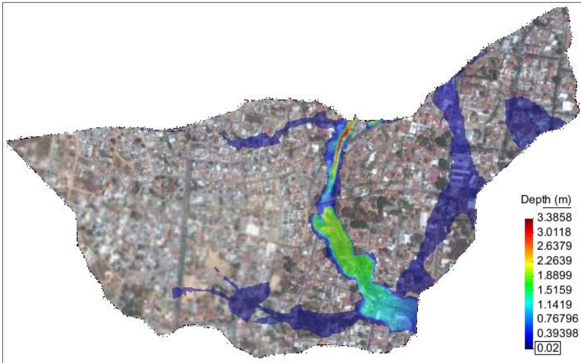
Ilustración 7.28. Nivel máximo del agua, debido a una tormenta con d=24 hr y Tr=25 años. Subcuenca Colector con topografía modificada
