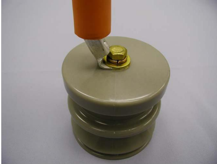
Figura 15. Conexión del cable de alta tensión
