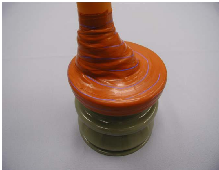
Figura 18. Uso de la cinta de silicón
