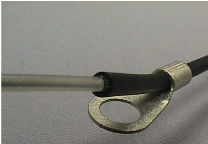
Figura 20. Preparación del cable coaxial
