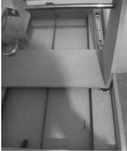
Ilustración 72. Rieles para el sistema de movimiento en el eje Y. Autor.
