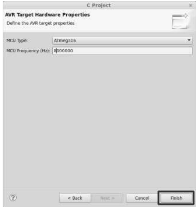
Ilustración 102. Frecuencia del microcontrolador a través de Eclipse. Autor
