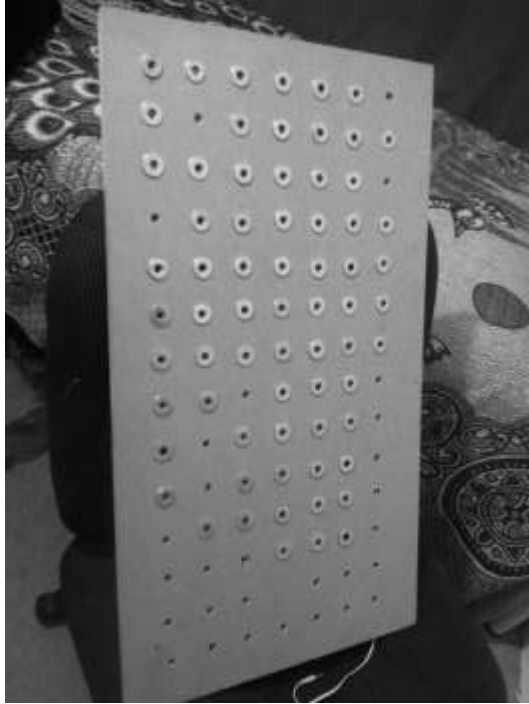
Ilustración 74. Mesa de trabajo para el Router CNC. Autor.
