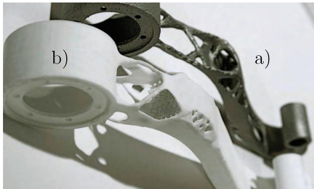
Figura 3. a) Soporte de monitor construido mediante manufactura convencional y b) soporte construido mediante manufactura aditiva [7].
