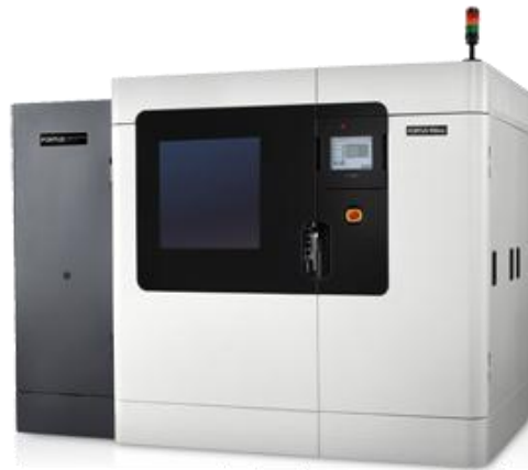
Figura 7. Máquina de manufactura Aditiva FDM, Fortus® 900, desarrollada por Stratasys [12].
