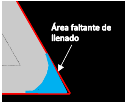
Figura 30. Área faltante de llenado en esquinas.
