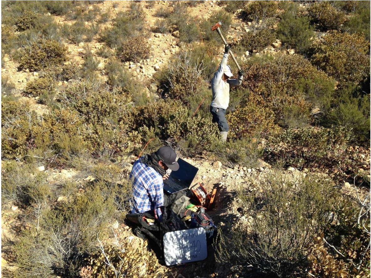
Fig. 3-5 Brigada realizando un TRS en el cadenamiento 600+000 utilizando un marro de 20 lbs como fuente de energía
