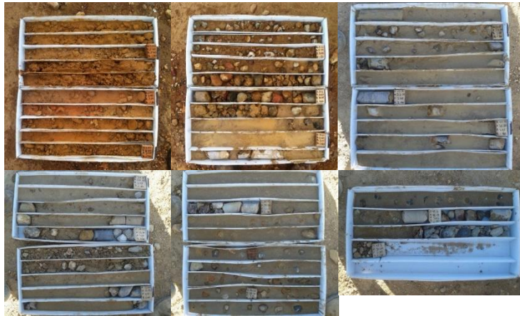
Fig. 4-2 Núcleo recuperado del sondeo en roca en el cadenamiento 600+000
