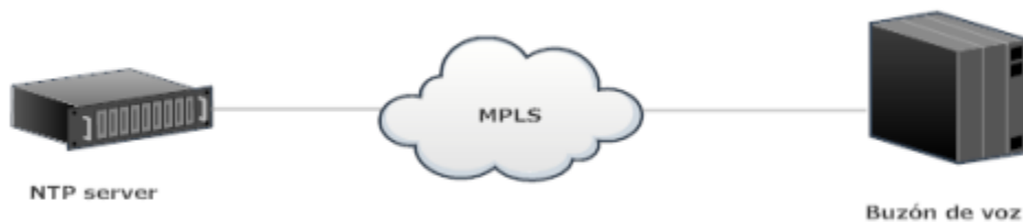
Fig.14 Sincronía del NTP server hacia el buzón de voz
