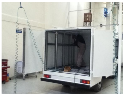
Figura 27. Instalación de estantería.
