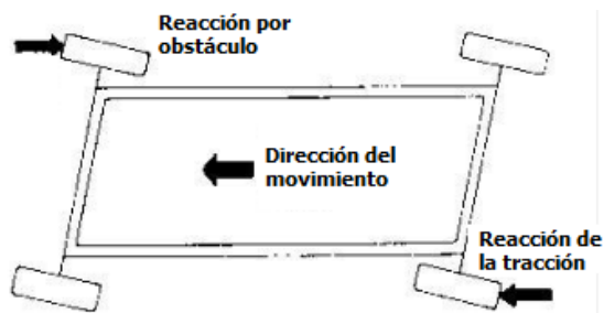
Figura 10-Deformación horizontal en rombo [7]
