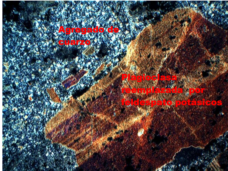
Figura 71. Agregado microcristalino de cuarzo que rodea a un fenocristal de plagioclasa reemplazado en su totalidad por feldespato potásico (alteración potásica) (Microfotografía a 5x, luz polarizada). Barreno MM-118 a 76 metros de profundidad.
