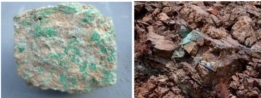
Figura 79. Muestra de mano sin escala (a la izquierda) con crisocola encontrada de la zona superficial del depósito de Iguana Prieta. A la derecha afloramiento del depósito de La Virgen con presencia de malaquita, goethita-limonita, hematita, azurita y crisocola (Brian K. Jones, 2007).
