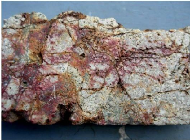
Figura 54. Pórfido monzonítico moderadamente intemperizada que muestra una capa de óxidos de color rojizo (goethita y hematita) junto a silicificación entre las fracturas (cuarzo en cristalizaciones finas) y se observa un intenso desquebrajamiento (Brian K. Jones, 2007).
