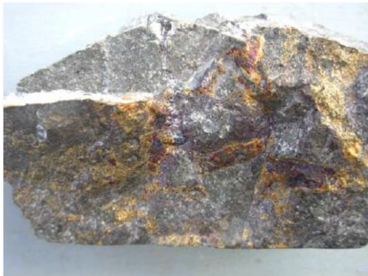
Figura 82. Andesita con alteración propilitica que muestra mineralización de bornita y calcopirita a lo largo del plano de fractura. Barreno MM-128 a 53 metros de profundidad con 2.47% de cobre (Brian K. Jones).
