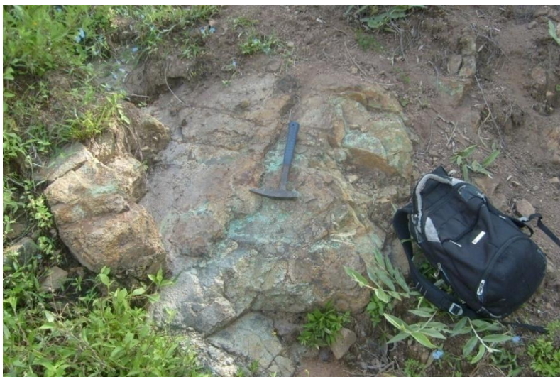
Figura 51. Afloramiento de cuarzomonzonita intensamente intemperizada del cuerpo de Playa Azul con intensa argilización, presencia de óxidos de hierro (hematita y goetita) y mineralización supergénica variable (malaquita).
