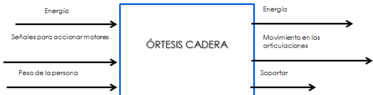
Fig. 2.2.1 Caja de funciones. Sistema en general
