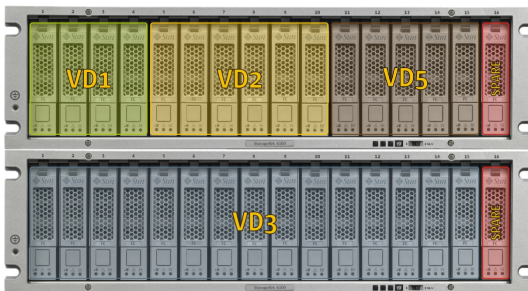
Figura 4.7. Nueva propuesta de configuración del arreglo Sun StorEdge 6140.
