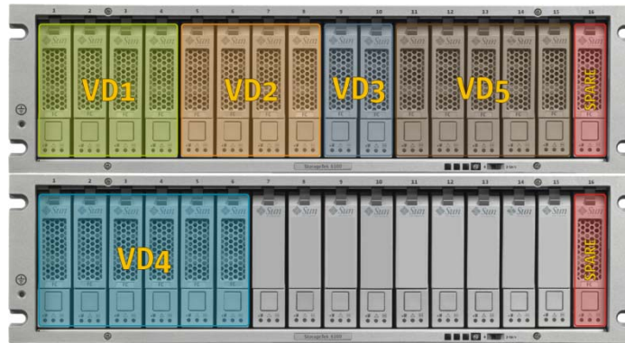
Figura 3.3. Distribución de espacios y niveles de RAID en el arreglo de discos.
