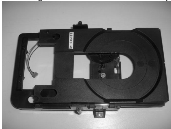
FIGURA 4.22: MECANISMO INTERNO DE UN REPRODUCTOR DE DISCOS COMPACTOS
