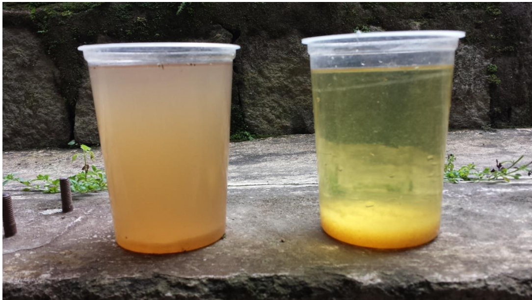
Figura 6.7 Prueba de coagulación de agua de despulpado, antes y después de la adición de cal
