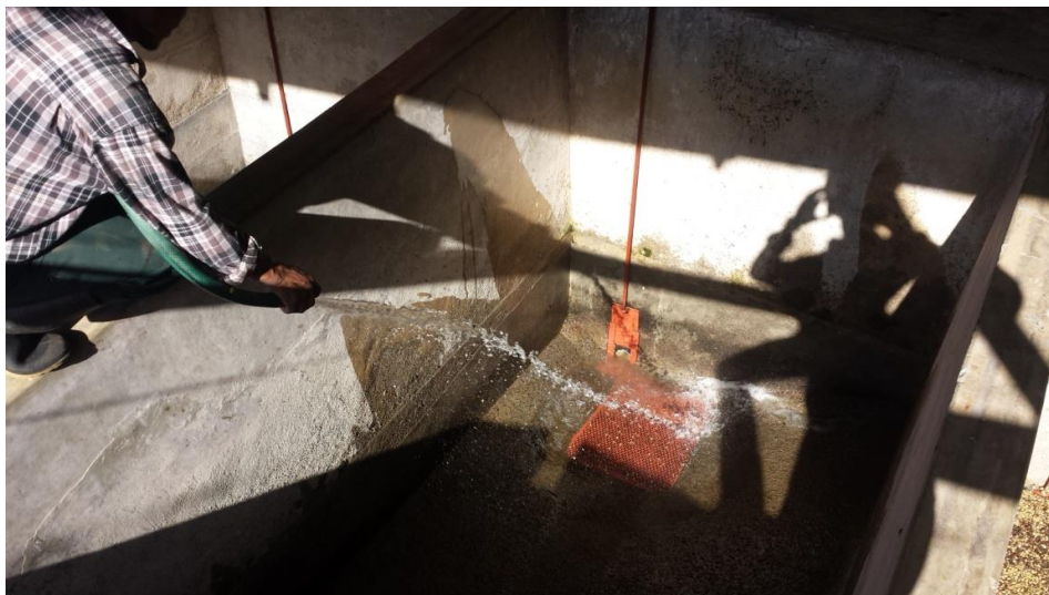
Figura 6.5 Tamiz de drenado al fondo de los tanques de fermento
