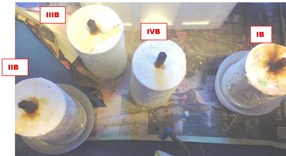
FIGURA 4.8 Probetas del grupo 2, con alrededor de 170 ciclos de ensayo de corrosión acelerada.
