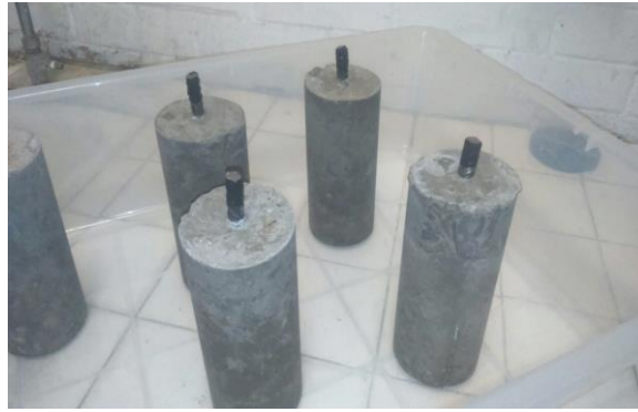
Figura 3.3 Forma final de las probetas después de haber sido desmoldadas.
