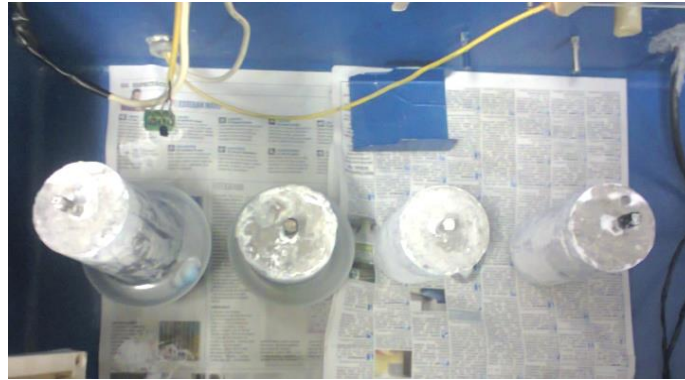
FIGURA 4.4 Probetas del grupo 1, antes de iniciar los ensayos, de izquierda a derecha están en el siguiente orden, I, II, III, IV, recordando que las probetas II y II están sumergidas parcialmente en solución salina al 3.5%.
