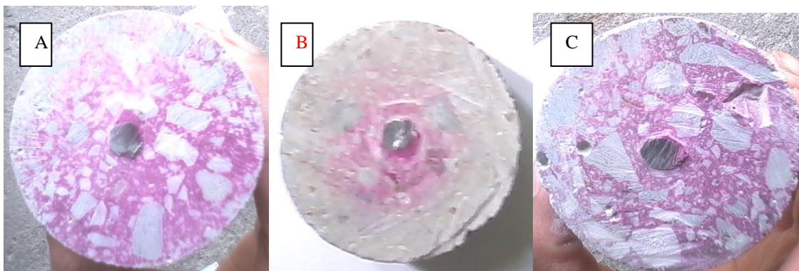
FIGURA 4.3 Muestra el cambio de coloración en las secciones que fueron cortadas las probetas, estas corresponden a la probeta I y II (inmersas en solución salina)
