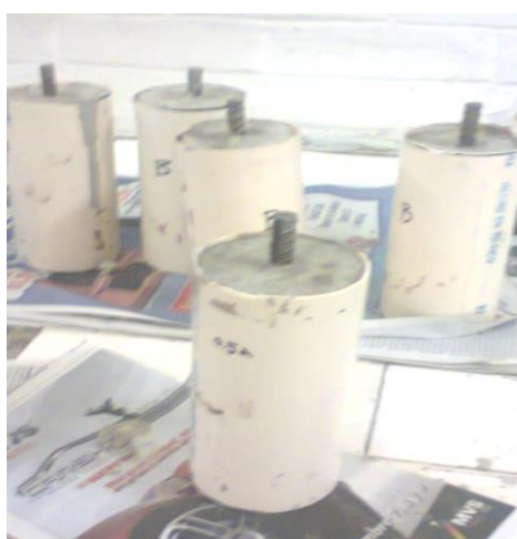
Figura 3.2 Probetas después del vaciado de la mezcla
