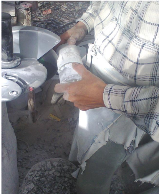
Figura 3.9 Muestra cómo se realizo el corte seccional a cada probeta
