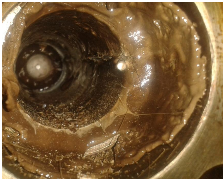
Ilustración 14 Alojamiento de boquilla con material atascado
