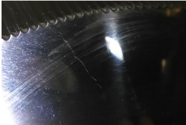
Ilustración 7 golpe en corazón debido a la extracción forzada de una pieza atascada
