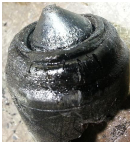
Ilustración 9 material fugado debido a dispensador dañado.
