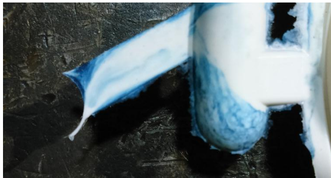
Ilustración 31 muestra de una pieza con falta de sello en ventil
