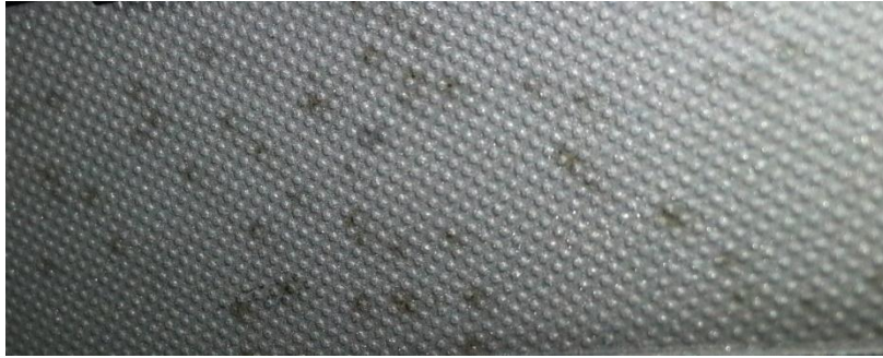
Ilustración 23 Marcas en texturizado provocadas por mala manipulación de molde
