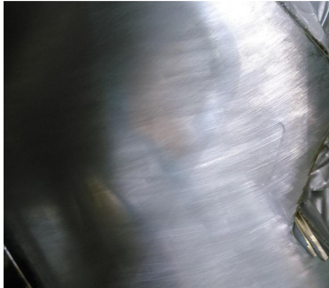
Ilustración 6 molde en proceso de pulido para eliminación de defectos.
