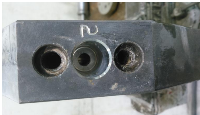
Ilustración 30 muestra de los circuitos tapados
