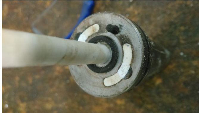
Ilustración 29 muestra de refrigeración tapada
