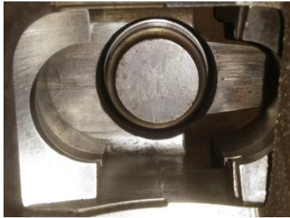
Ilustración 19 contrasalida en momento de desmoldeo
