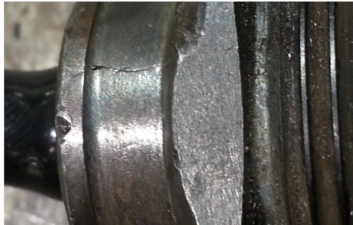
Ilustración 8 dispensador con fisura
