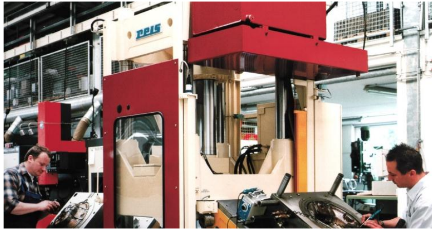
Ilustración 4 muestra de una máquina para sellado de moldes.
