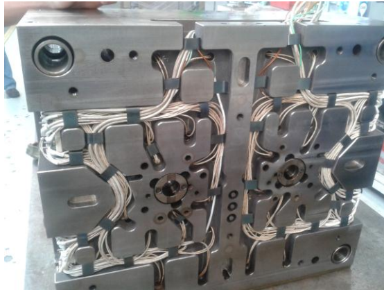
Ilustración 13 distribución de resistencias en molde de termofijo.
