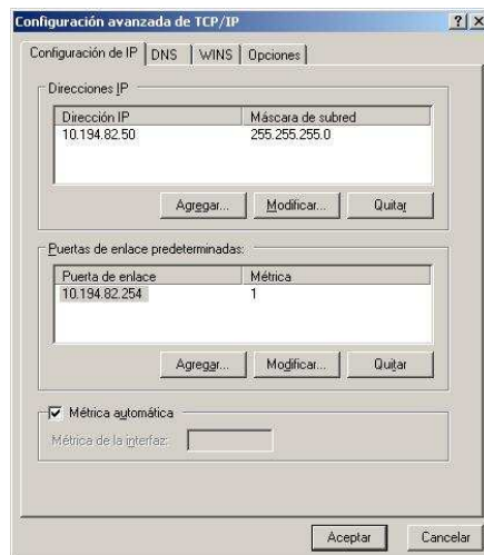
Figura 1.7 Ejemplo de Configuración de interfaz PR1. Proceso de desenmascaramiento de puertos.
